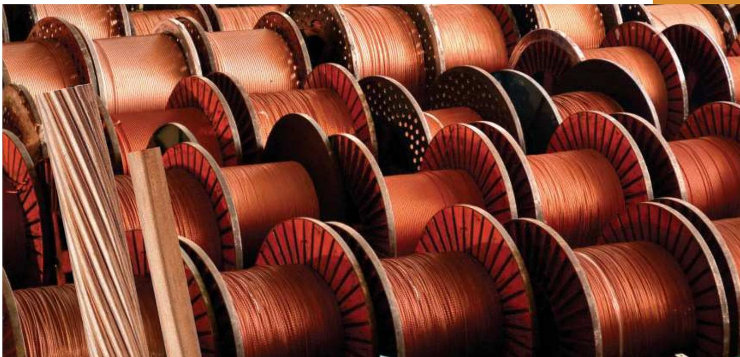
*Los conductores de Cobre Desnudo son usados para transmisión y distribución de energía eléctrica principalmente en líneas aéreas y en sistemas de puesta a tierra.*
