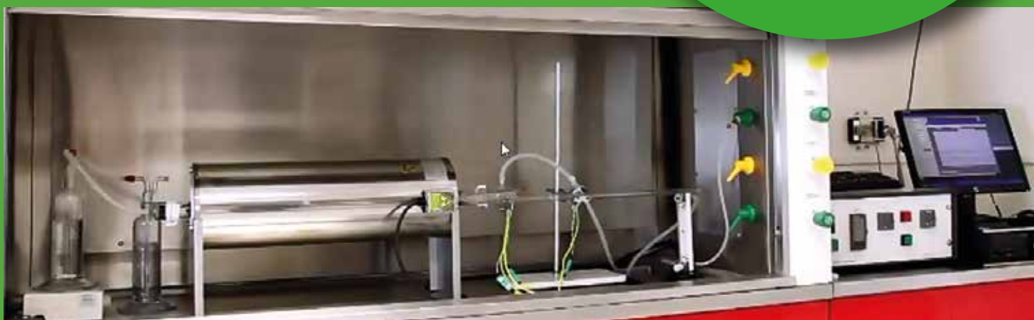
Equipo para realizar el ensayo de baja emisión de humos densos, tóxicos y corrosivos según IEC 60754-1-2
