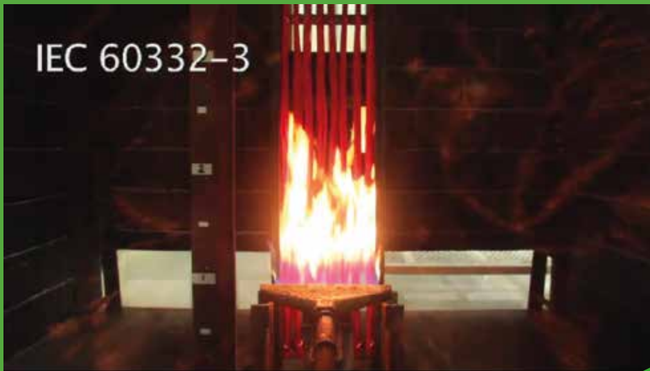
Prueba de llama según IEC 60332-3
