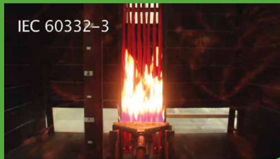
Prueba de llama según IEC 60332-3
